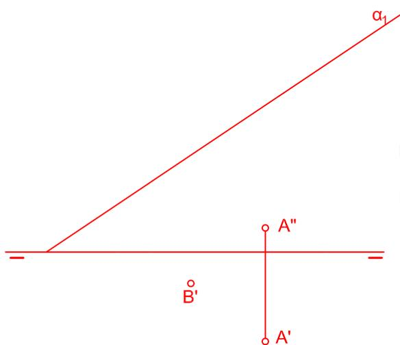
CALCULAR LA PROYECCIÓN DE UN TRIÁNGULO EQUILÁTERO SITUADO EN EL PLANO  $\alpha$  ( $\alpha_1\alpha_2$ ) SOLAMENTE SE CONOCE LA TRAZA VERTICAL. LOS PUNTOS A Y B SON DOS DE SU VÉRTICES. EL OTRO VÉRTICE, C, HA DE TENER LA MAYOR COTA POSIBLE.
