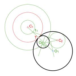
TRAZAR LAS TANGENTES  $t_1$  Y  $t_2$  A LA HIPÉRBOLA DADA POR EL EJE REAL Y LA DISTANCIA FOCAL, PARALELAS A LA DIRECCIÓN DADA "d", HALLAR LOS PUNTOS DE TANGENCIA.
